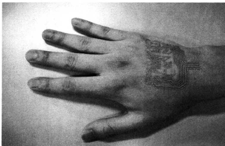
手の甲に装着した皮膚貼り付け型ナノメッシュ電極。1週間貼り付けたままでも炎症反応がみられず不快感がない。
